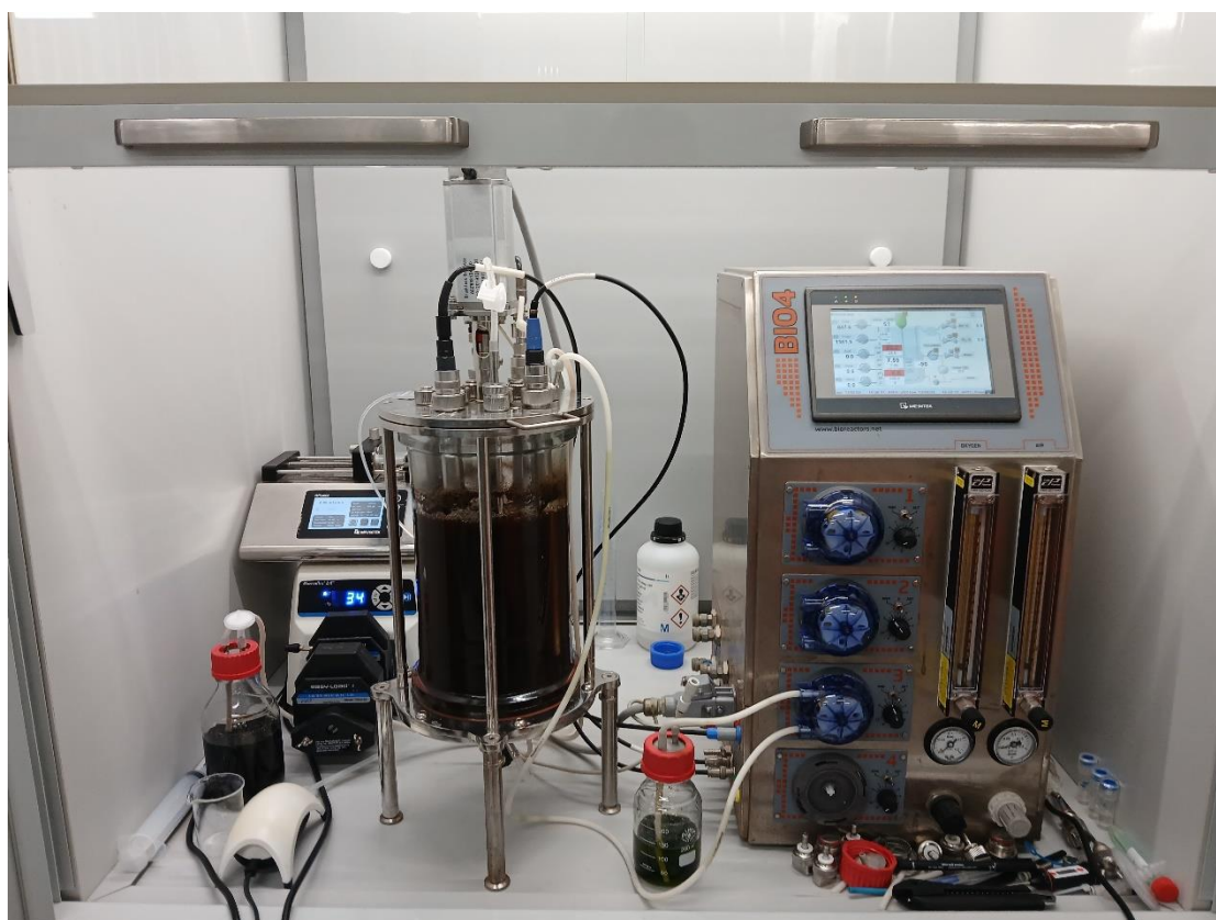
1.attēls. Laboratorijas mēroga bioreaktora sistēma SIA "Getliņi EKO" industriālās attīrīšanas procesa replicēšanai.
